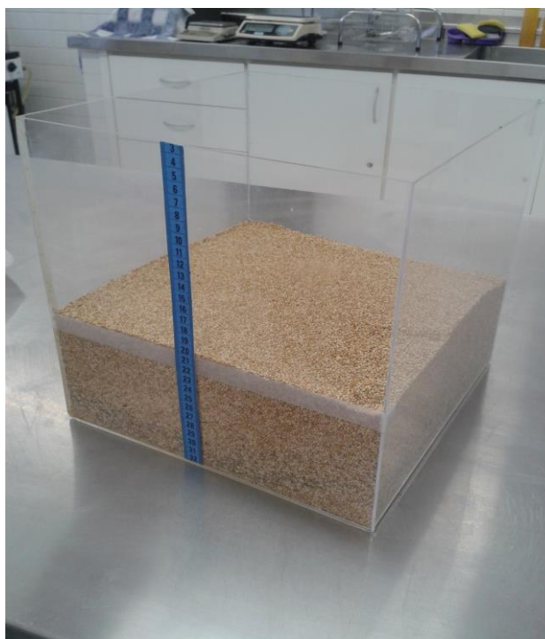
Fotografia 1 - Instrumento de medição do volume dos pães.
