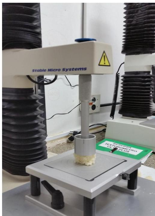
**Fotografia 2.** Texturômetro em funcionamento.
