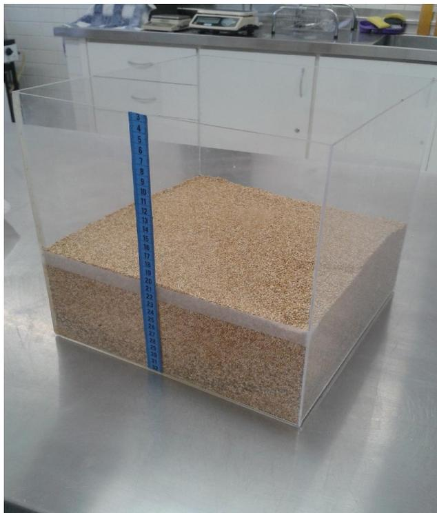
**Fotografia 1. Instrumento de medição do volume dos pães.**
