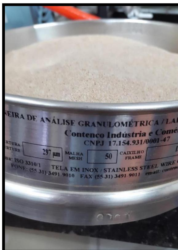
**Figura 12 - Amostra retida na Peneira de mesh 50**
