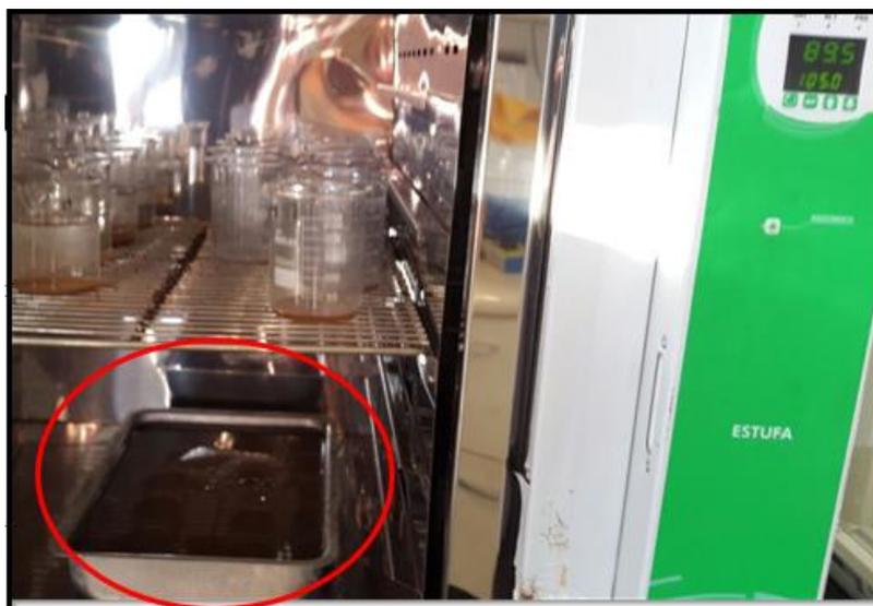
**Figura 10 - Forma contendo amostra na estufa**
