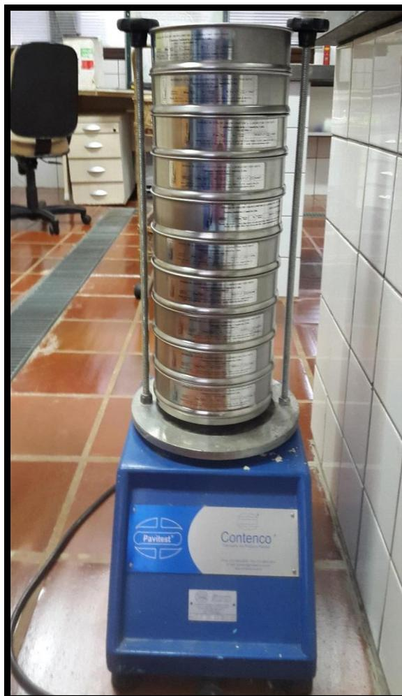
**Figura 11 - Peneiras empilhadas no agitador eletromagnético**
