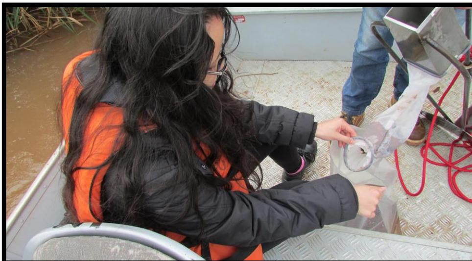
**Figura 7 - Amostra sendo retirada do amostrador e guardada em saco plástico**
