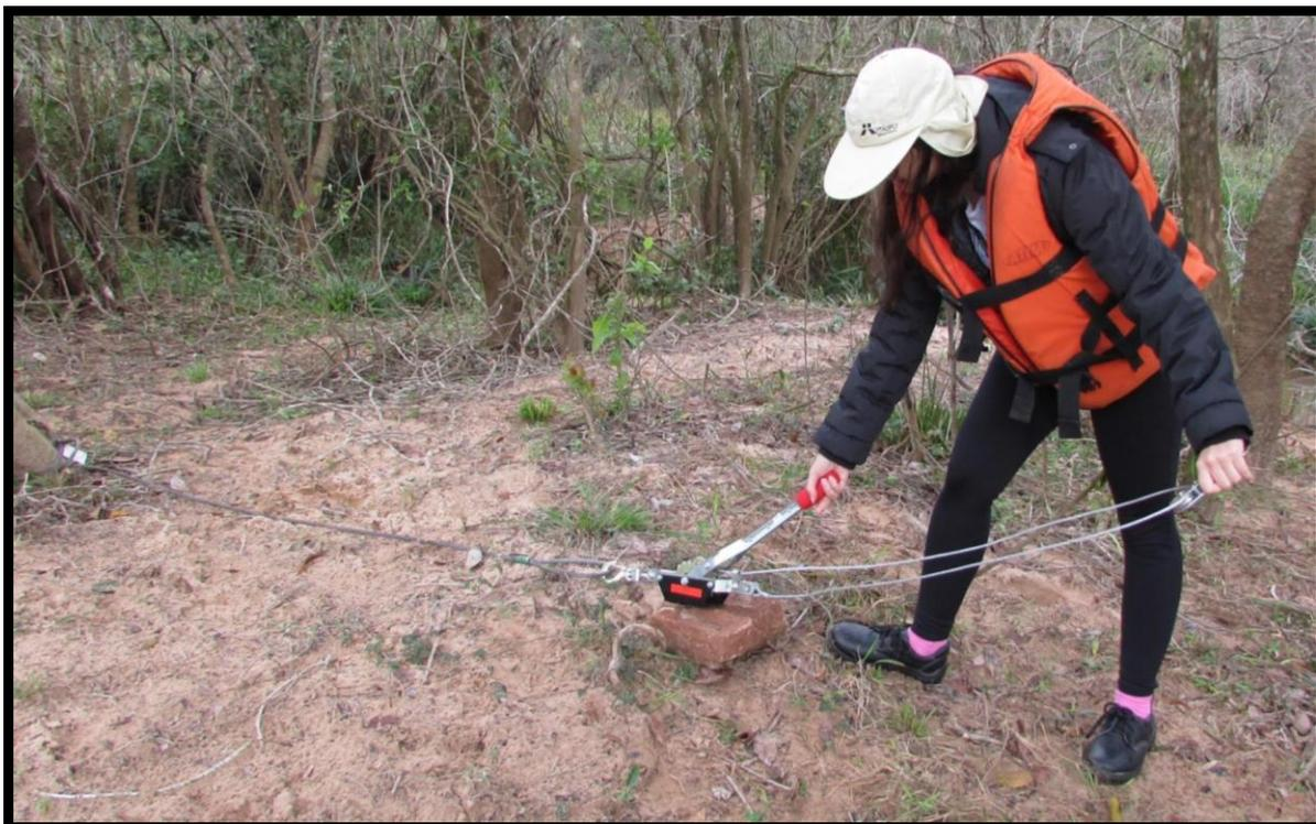
**Figura 4 – Guincho manual titor utilizado para esticar o cabo de aço**
