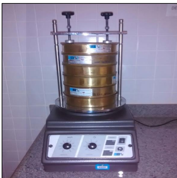
Figura 12 – Agitador de peneiras para determinação da granulometria
