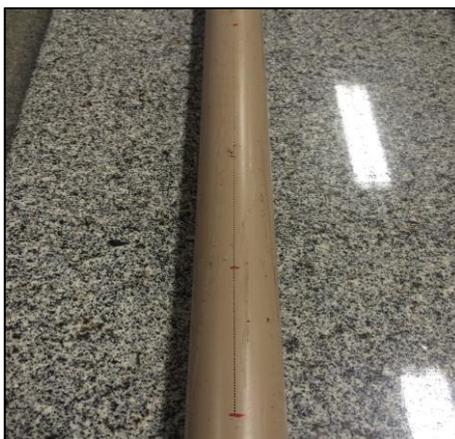
**Figura 6 - Tubo perfurado pela CNC.**
