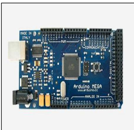
**Figura 5-e - Placa Arduino MEGA.**
