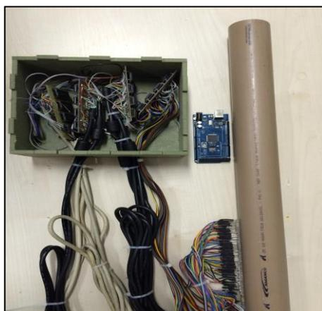
**Figura 9 - Placa com os multiplexadores dentro da caixa de proteção.**
