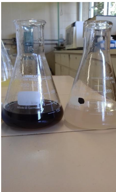
Figura 17: Mudança de cor na amostra durante o teste de índice de peróxido.
