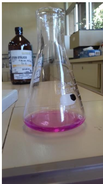
Figura 16: Coloração adquirida pela amostra durante o teste de índice de acidez.
