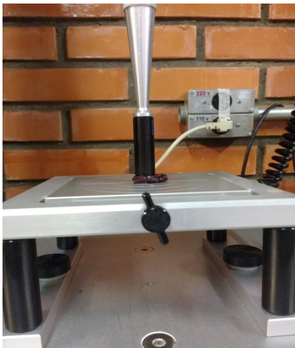
Figura 4 – Análise instrumental de textura (TPA) da cranberry desidratada Fonte: Próprio autor.
