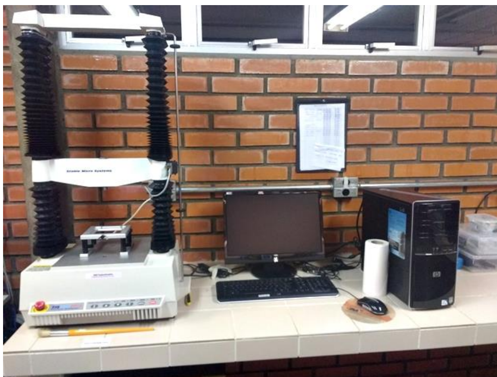
Figura 6 – Texturômetro universal, utilizado para a medição instrumental de textura das berries
