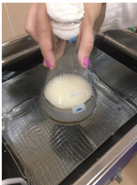
Figura 5 – Aplicação de ultrassom durante a fermentação de hidrolisado de FAD. Fonte: a autora (2018).
