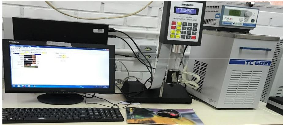
**Figura 8.** Viscosímetro rotacional de cilindros concêntricos.
