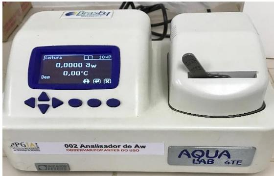
**Figura 6.** Medidor de atividade de água.
