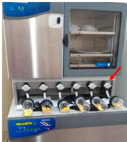
Figura 2 - Liofilizador labconco com os recipientes acoplados contendo as amostras de manga para realização da cinética de secagem.
