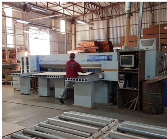
Figura 14- Seccionadora Fonte: Autoria Própria (2018).
