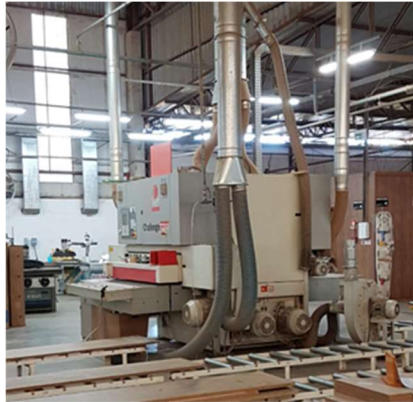
Figura 19- Lixadeira Fonte: Aatoria Própria (2018).
