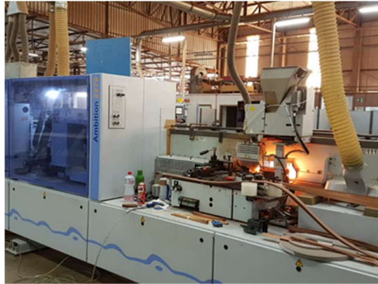
Figura 17- Coladeira de borda Fonte: Aatoria Própria (2018).
