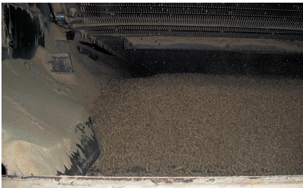
Figura 17. Foto do resfriador demonstrando os grânulos peletes e finos. Fonte: O Autor.
