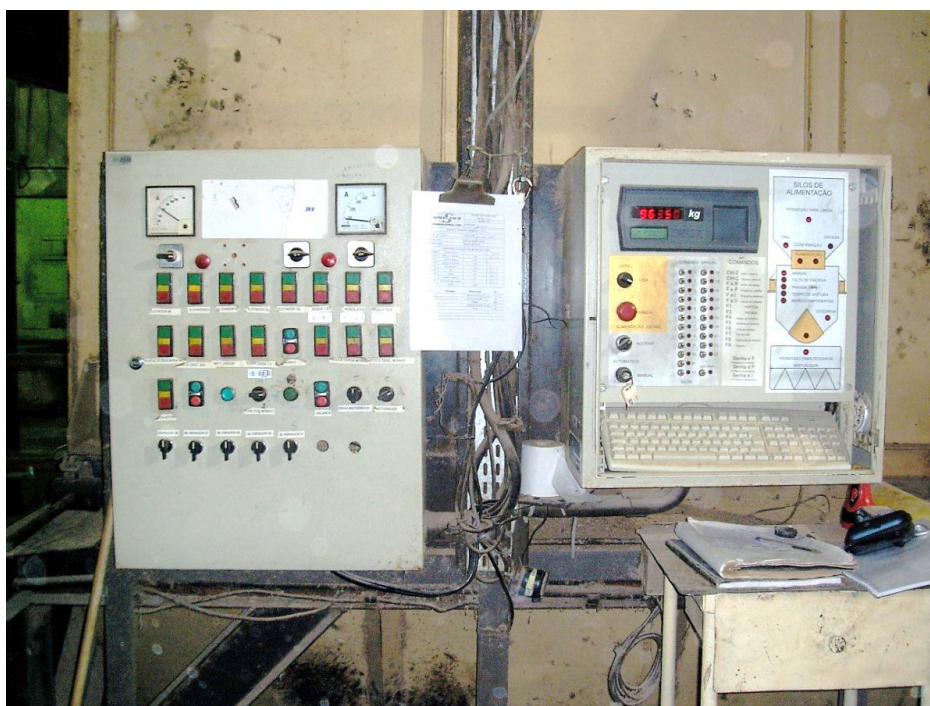
Figura 16. Foto do painel de controle do processo (direita) e do painel da balança das matérias-primas (esquerda) indicando a massa. Fonte: O Autor.
