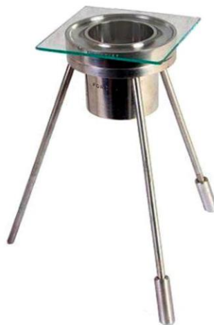
Figura 12 - Copo de Ford utilizado para medir viscosidade. Fonte: http://www.tecnoferramentas.com.br/viscosimetro-completo-com-tripe-e-copo-ford-n4-astm-d-5293-e-sae-j30_tecno-tec_7104/p
