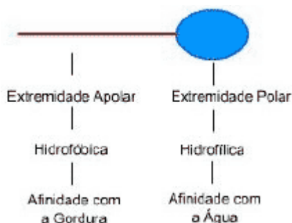
Figura 8 - Estrutura de um Tensoativo Fonte: MISIRLI (2012).
