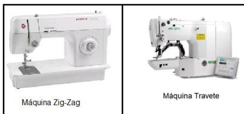
**Figura 12 Máquinas Utilizadas na etapa de acabamento no Processo de Fabricação de Sutiãs**
