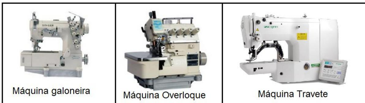
**Figura 15 Máquinas utilizadas no processo de confecção de calcinhas**
