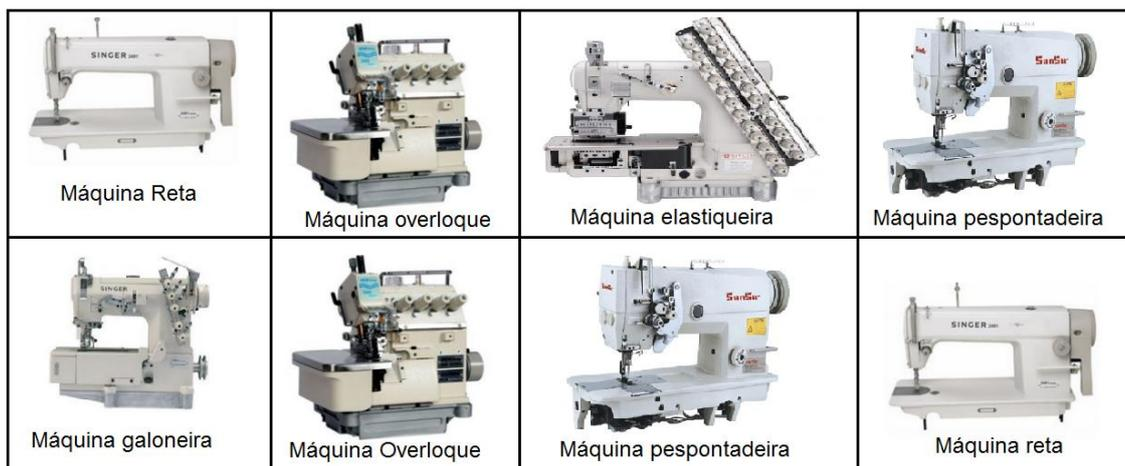
**Figura 11 Máquinas Utilizadas no Processo de Confeção de Sutiãs**
