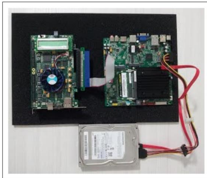
Figura 18: Foto da plataforma de hardware disponível para aplicação em análise composta por uma placa-mãe com processador Atom e uma placa com FPGA da família Cyclone IV.
