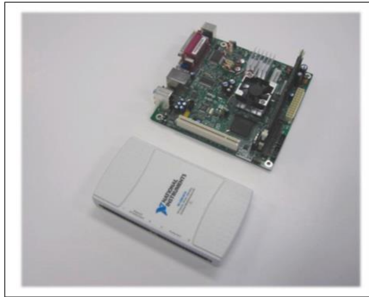
Figura 12: Imagem dos principais componentes do plataforma LEAP. O DAQ da National Instrument, à esquerda e a placa-mãe Atom, à direita.
