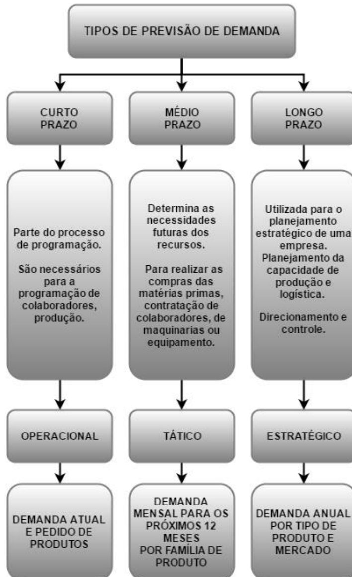
Figura 16: Fluxograma ilustrativo dos tipos de Previsão de Demanda e as descrições. Fonte: Autoria Própria. Adaptado de: Hyndman e Athanasopoulos (2016) e Lustosa et al (2008).
