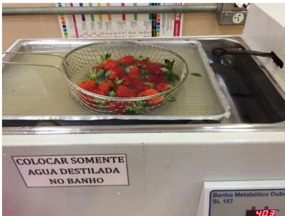
Figura 8 – Aplicação da cobertura de pectina a 2% p/p adicionada de ácido cinâmico. Fonte: Autoria própria (2017).
