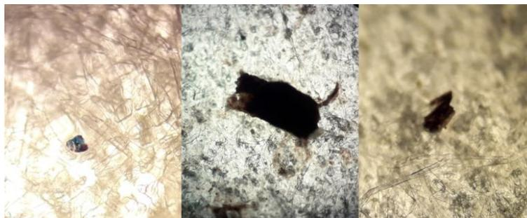
Figura 6 - Sujidades detectadas nas amostras MC1, MC4 e MO2, respectivamente da esquerda para a direita, ambas ampliadas 10 x em microscópio óptico.
