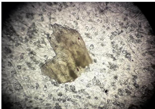
Figura 9 - Exemplo de bagacilho encontrado em sete amostras de açúcar mascavo, ampliadas 10 x em microscópio óptico.
