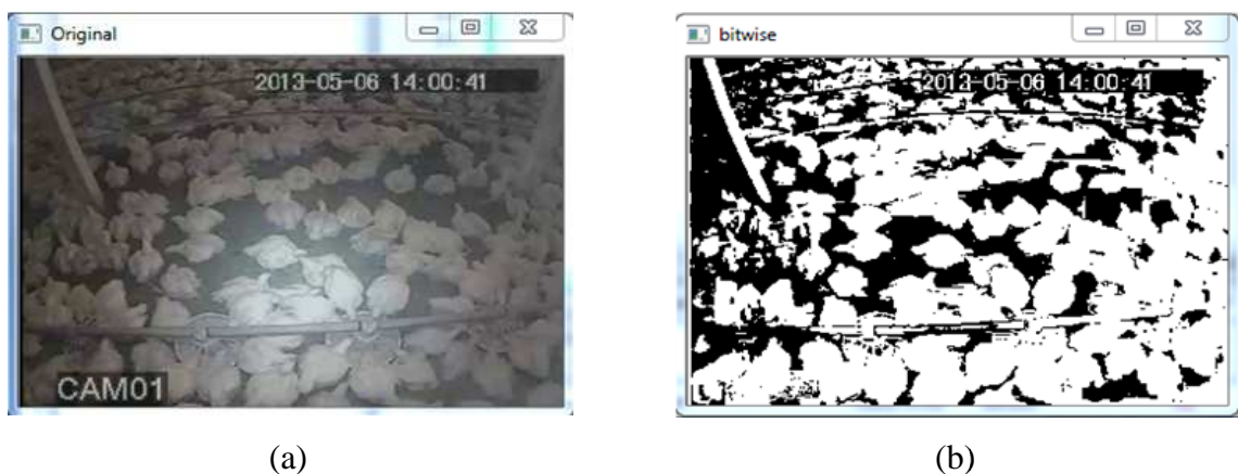
Figura 11 - Imagem após subtração de fundo e inRange . Fonte: Autoria própria.
