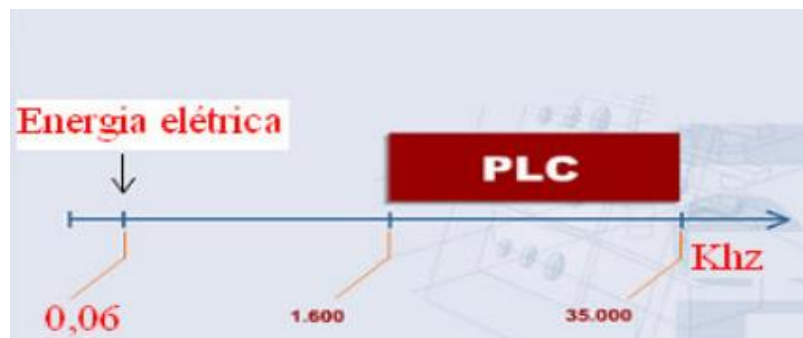
Figura 3 - Espectro de frequência PLC
