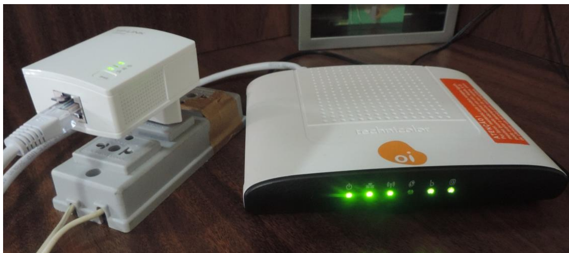
Figura 6 - Alimentação do equipamento PLC através do sinal gerado pelo Modem ADSL
