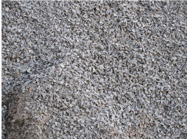
**Figura 2 – Pedrisco utilizado como agregado graúdo**
