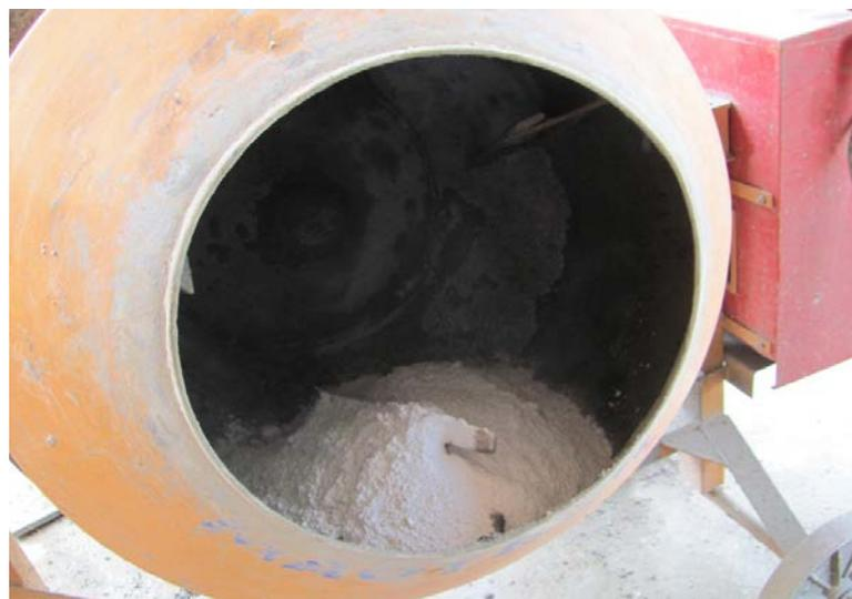
**Figura 9 – Betoneira utilizada na mistura dos componentes**
