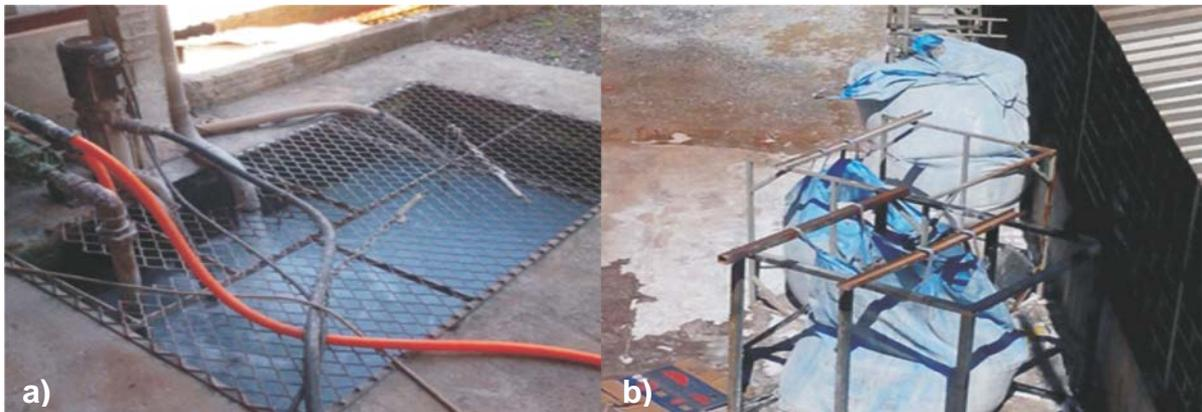
**Figura 4 – Geração do pó de vidro.** a) sistema de coleta do pó de vidro, b) secagem nos sacos
