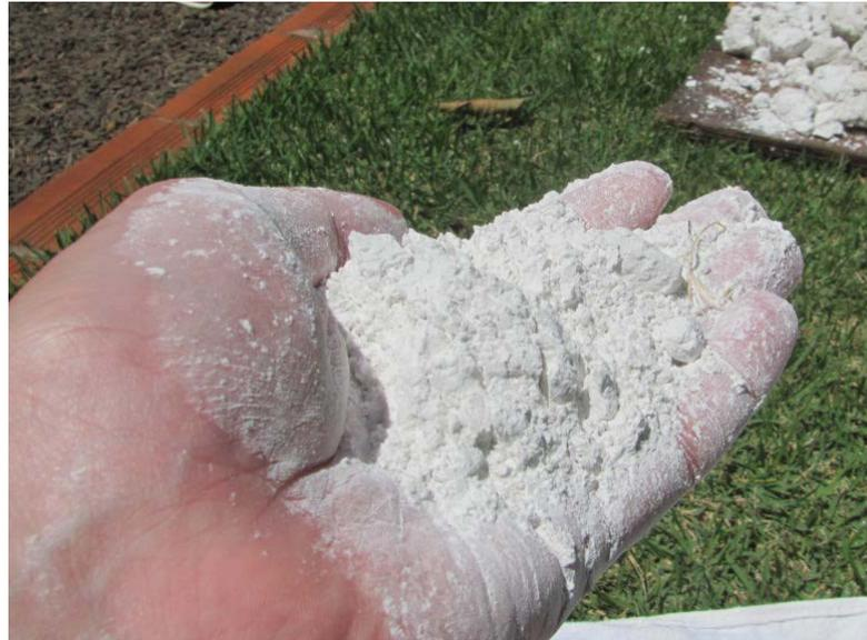
**Figura 3 – Agregado miúdo (pó de vidro)**
