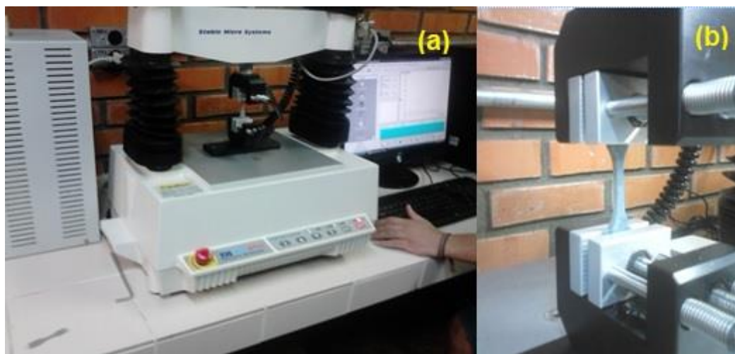
Figura 7 - Teste de tensão. (a) Equipamento do teste, (b) Corpo de prova preso no Equipamento.
