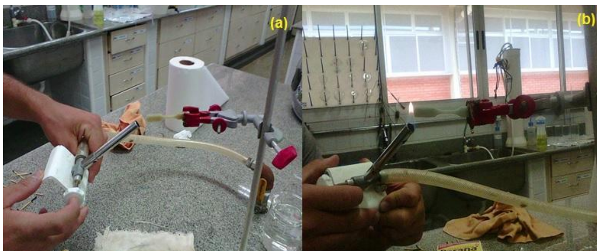
Figura 6 - Teste de inflamabilidade. (a) Preparação para o teste, (b) Realização do teste.
