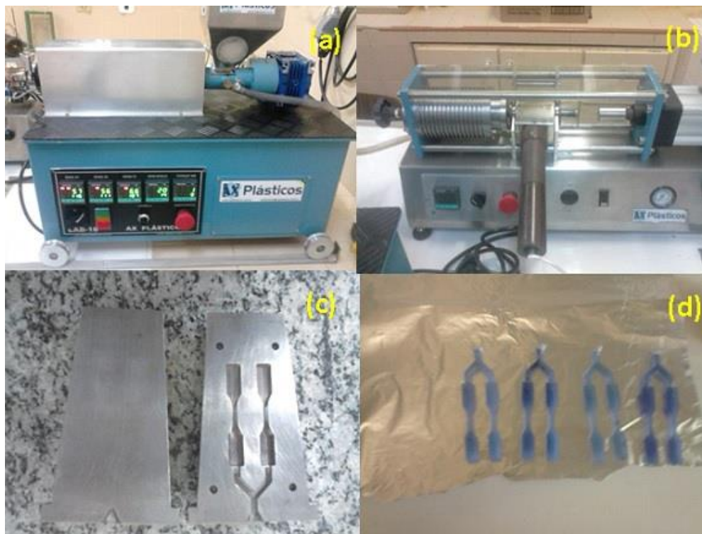
Figura 5 - Confeção dos corpos de prova. (a) Extrusora em preparação, (b) Injeção no molde, (c) Molde dos corpos de prova, (d) Compósitos prontos.
