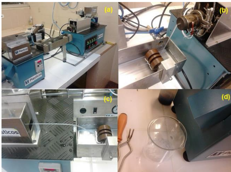
Figura 4 - Processo de extrusão e picotamento. (a) Extrusora em preparação, (b) Extrusão dos compósitos, (c) Compósito em processo de picotamento, (d) Compósito picotado.
