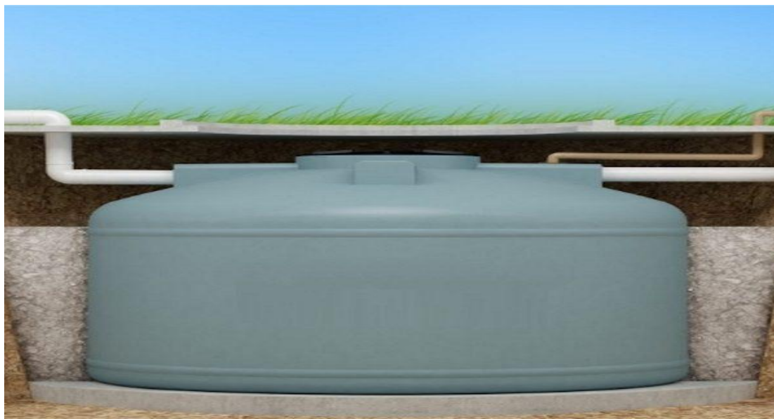
Figura 15: Cisterna subterrânea utilizada para o armazenamento de água.
