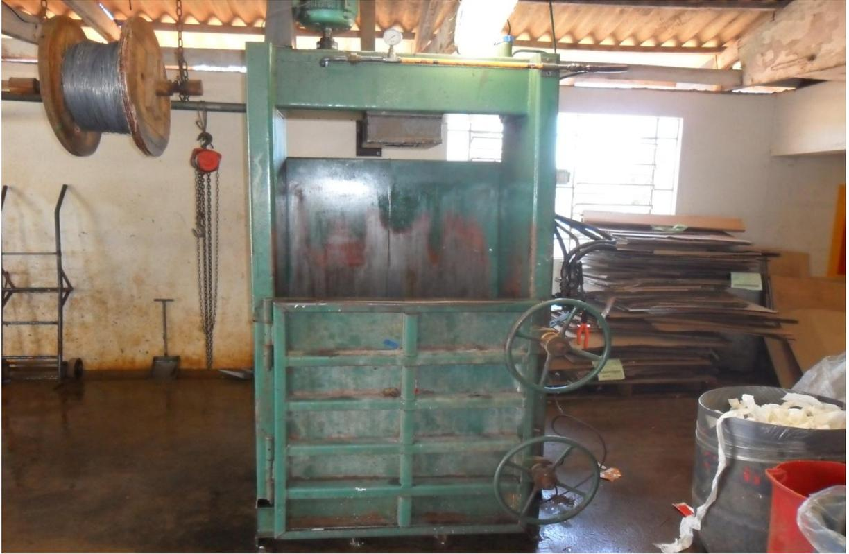
Foto 3: Máquina utilizada na compressão dos materiais recicláveis.
