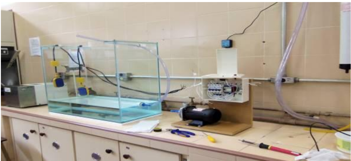
Figura 8- Sistema de reaproveitamento de água
