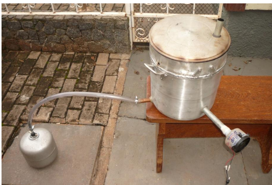
Imagem 8 – Ligação gás e cooler para entrada de ar Fonte: Rukat
