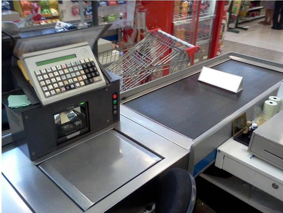
Figura 1 – Exemplo de um Caixa que contém Esteira e Balança. Fonte: Silva Diogo e Antunes Marcos
