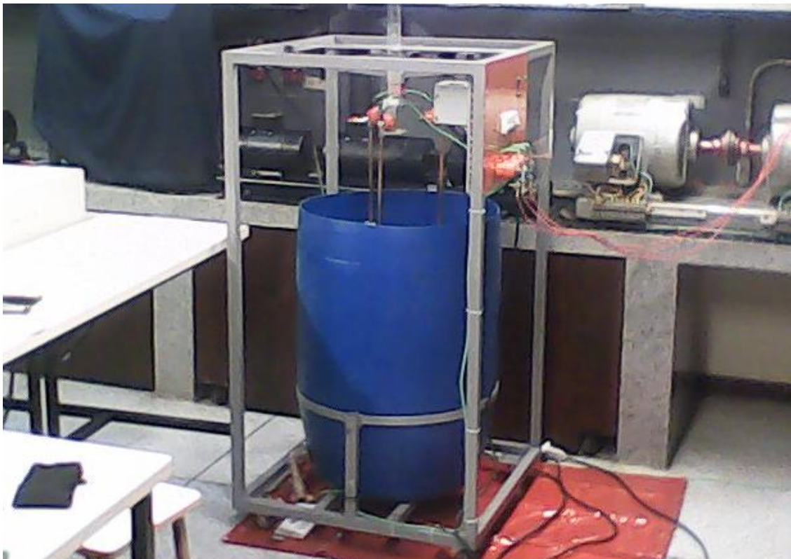
Figura 20 - Configuração Final da Carga Eletrolítica e Realização de Ensaios
