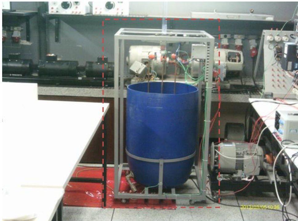
Figura 10 - Carga Eletrolítica depois da Montagem
