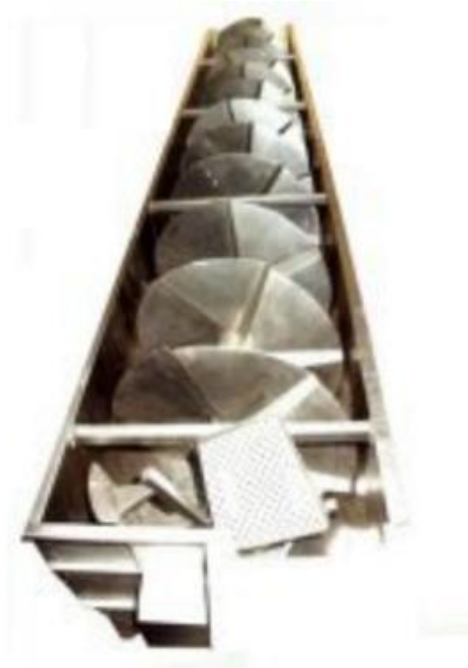
Figura 1: Detalhe da rosca sem fim; Fonte: FRIGOMAQ (2004).
