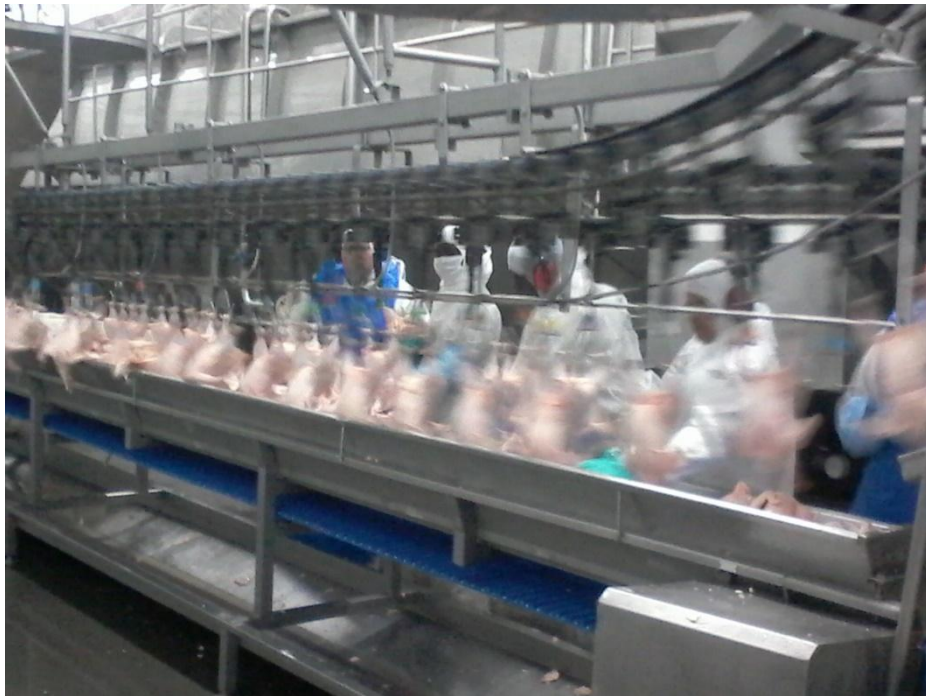
Figura 17: Gotejamento; Fonte: Autor.
