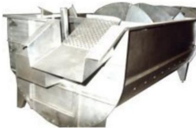
Figura 2: Detalhe mostrando o sistema de descarregamento das carcaças; Fonte: FRIGOMAQ (2004).
