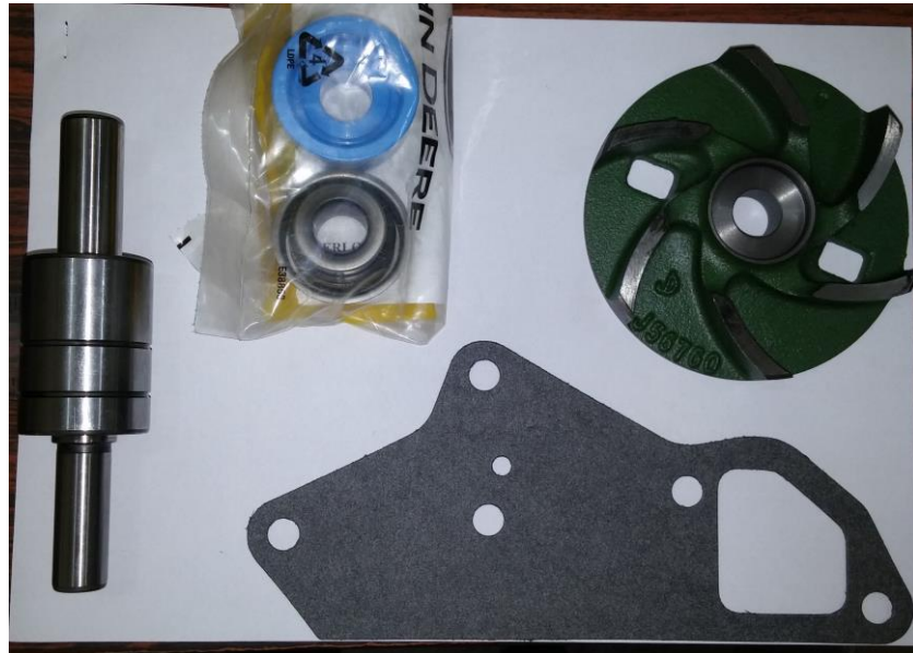
Figura 9 - Reparo da Bomba D'agua
