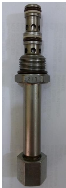
Figura 3 - Válvula fechada do comando hidráulico
