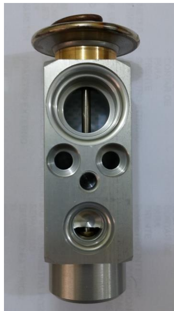
Figura 4 - Válvula de expansão do ar condicionado
