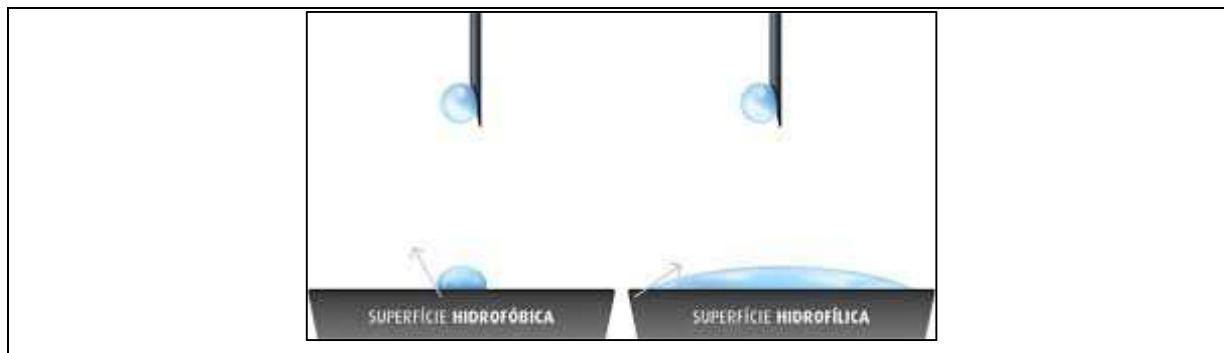
Figura 2 – Comportamento de um líquido exposto a superfície hidrofóbica e hidrofílica. Fonte: Alfaconnection (2014).
