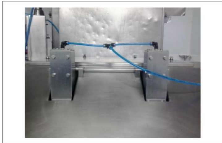
Figura 10 - Pontos de Lubrificação Fonte: Autor.
