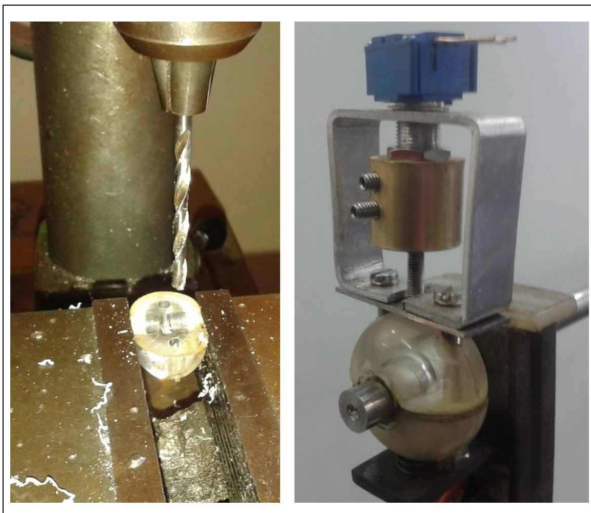
Figura 18: Detalhe da preparação do sistema de atrito (esquerda) e montagem no eixo do pêndulo com o potenciômetro de atrito instalado (direita).
