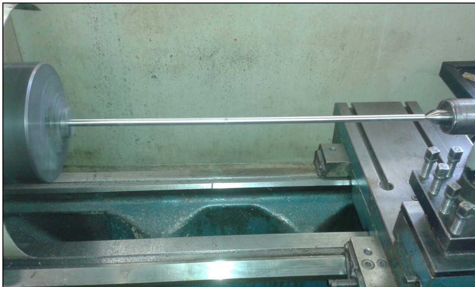
Figura 14: Detalhes da usinagem da haste horizontal em aço inox.
