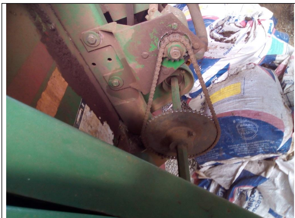
Figura 12: Engrenagem maior com a bucha sextavada e transmissão por corrente. Fonte: os autores.
