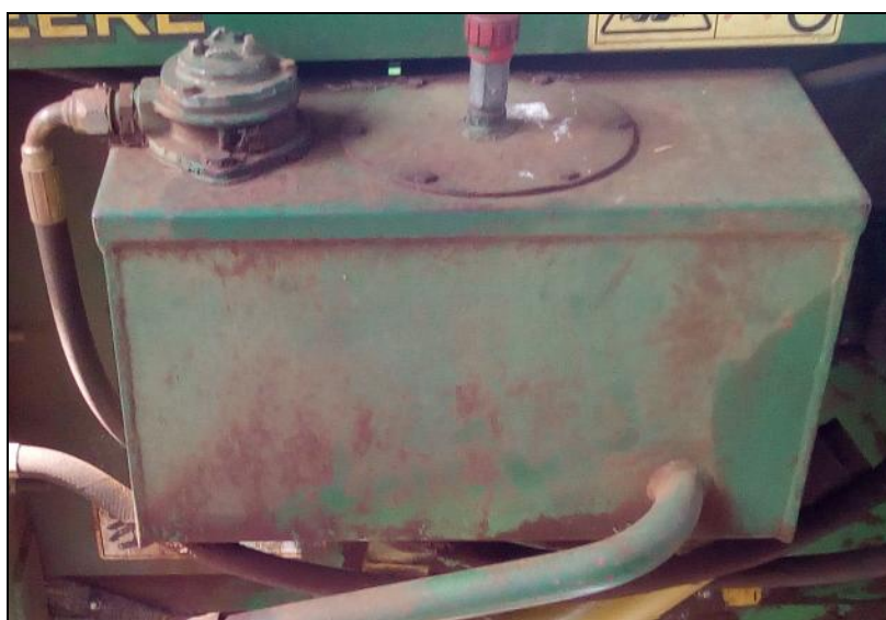
Figura 7: Reservatório de Óleo. Fonte: Os autores.
