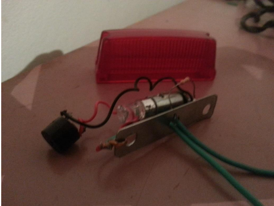
Figura 8 – Alarme sonoro e luminoso. Fonte: Autoria própria.
