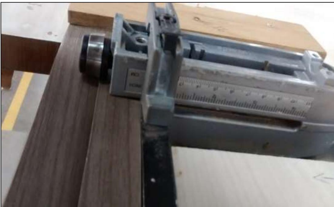
**Figura 12: Detalhe do dispositivo com indicação da medida da fita**
