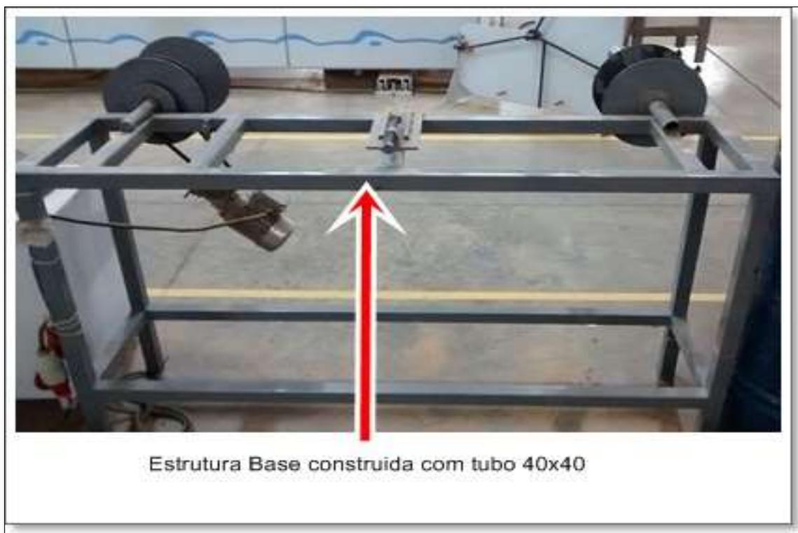
**Figura 5: Detalhe da estrutura base da máquina**
