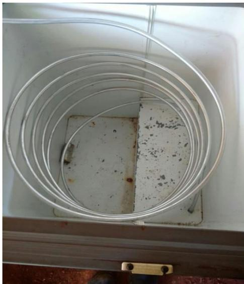
**Figura 6 - Serpentina montada no interior do freezer.**
