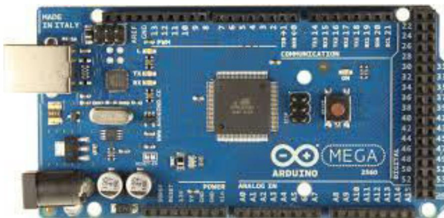
Figura 1 - Placa Arduino Mega
