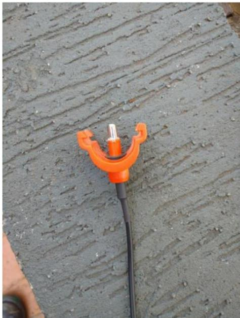
**Figura 8 - Sensor de temperatura DS18B20.**
