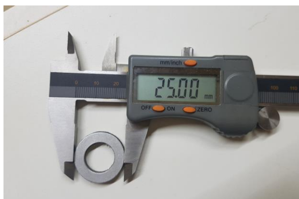
Figura 36- Peça usinada sendo feita a verificação do diâmetro externo.
