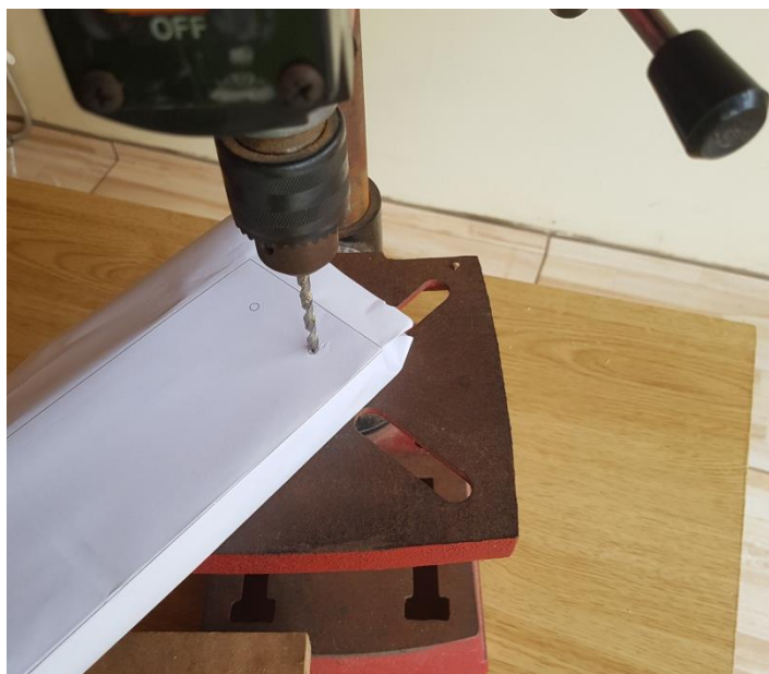
Figura 5 - Realizando as furações na peça utilizando o gabarito impresso e uma furadeira de bancada.
