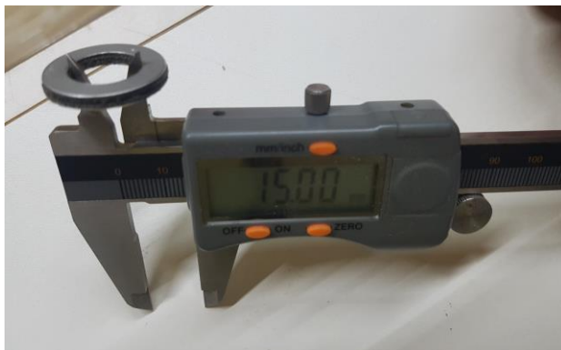
Figura 37- Peça usinada sendo feita a verificação do diâmetro interno.
