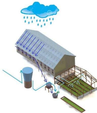
**Figura 6 – Captação de água da chuva.**
