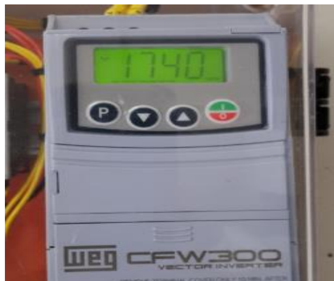
Figura 23 - RPM indicada no IHM do inversor de frequência.
