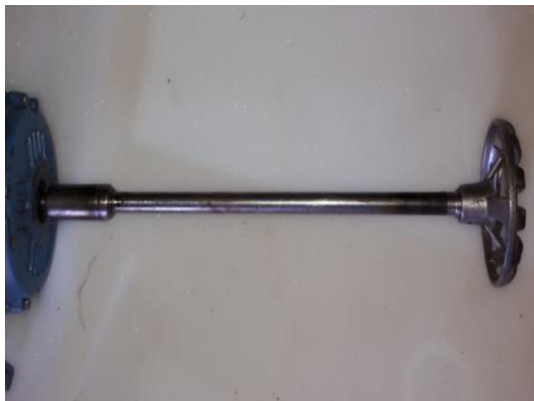
Figura 33 - Hélice e eixo já acoplados ao motor.
