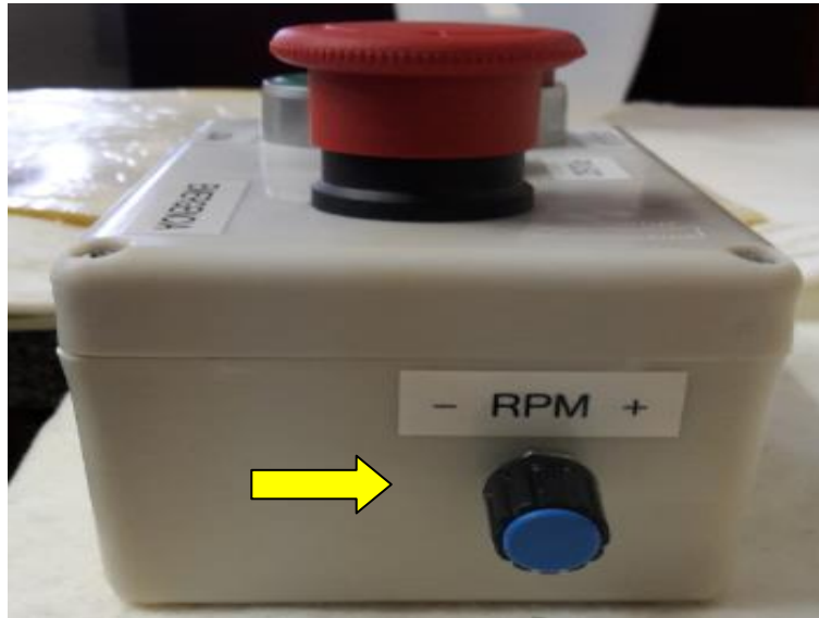
Figura 22 - Potenciômetro utilizado na regulação da rotação.
