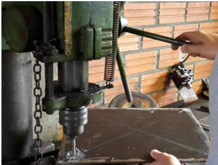
Figura 27 - Realizando furos nos cantos da chapa.
