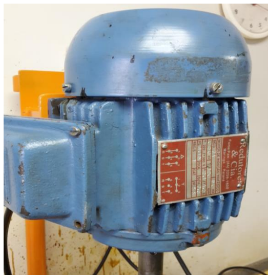
Figura 2 - Motor assíncrono utilizado no misturador
