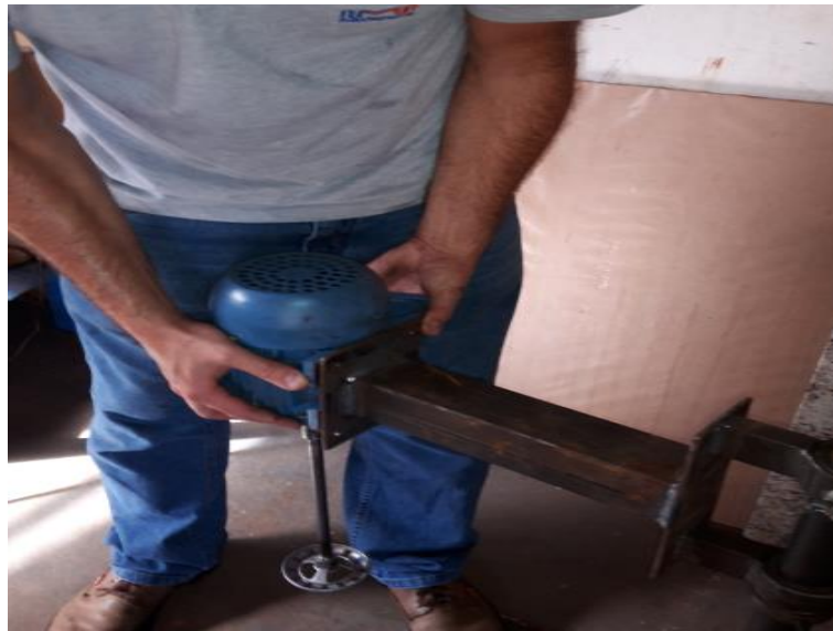
Figura 31 - Montagem do motor na estrutura.
