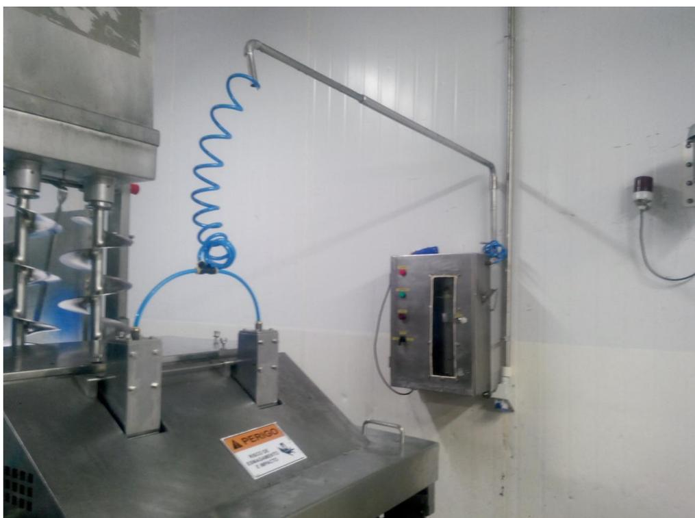
**Figura 4 – Alimentação de lubrificantes nos braços alimentadores**
