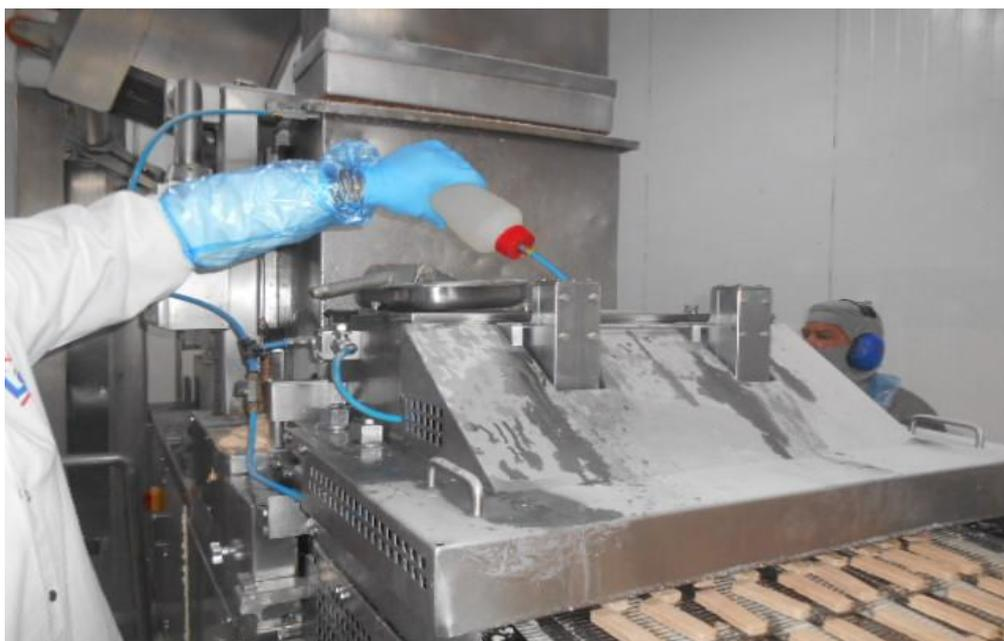
**Figura 1 – Lubrificação de forma manual**
