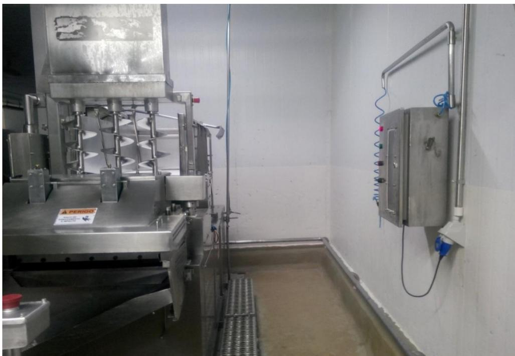
**Figura 5 – Disposição do quadro de controle em relação ao equipamento**
