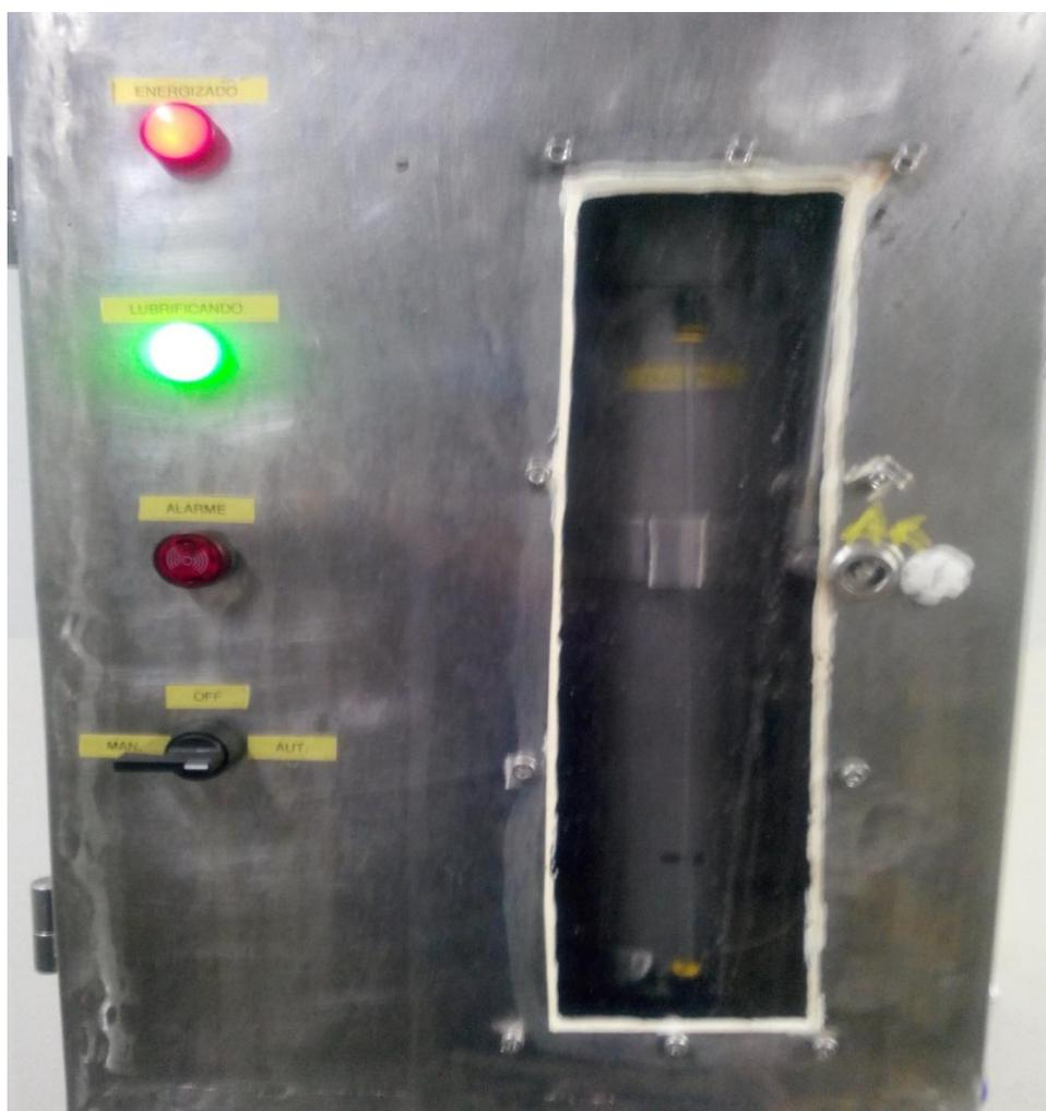
**Figura 6 – Quadro de comando lubrificando o equipamento**
