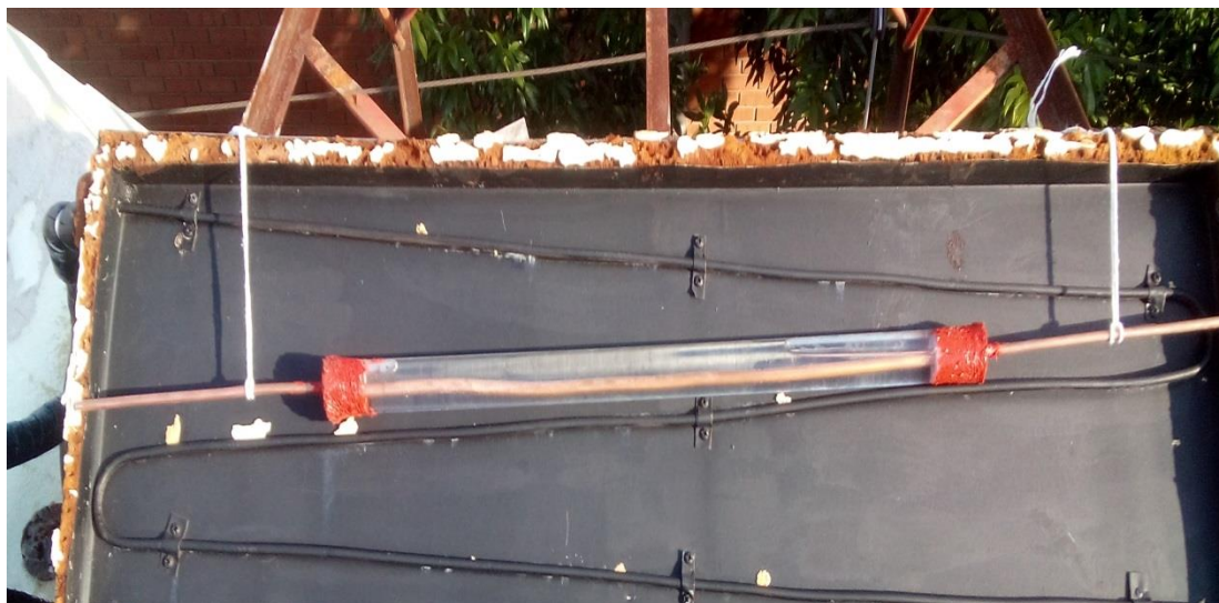
Figura 20: Configuração do tubo de vidro da lâmpada com água e com tubo de cobre embutido.
