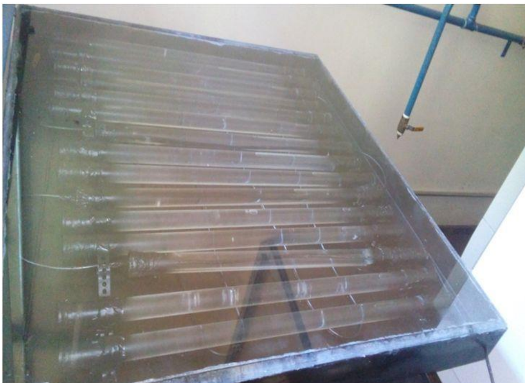
Figura 26: Coletor solar finalizado.
