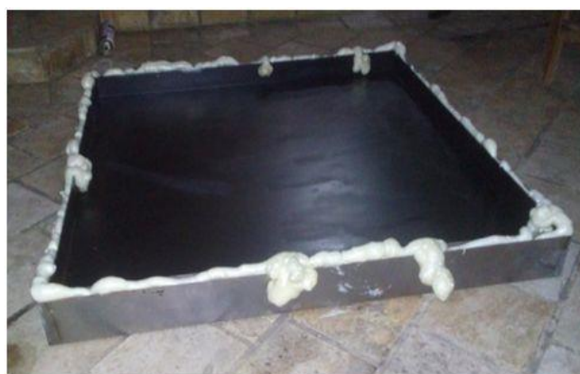
Figura 22: Base do Coletor com o material isolante e pintura na cor preta.
