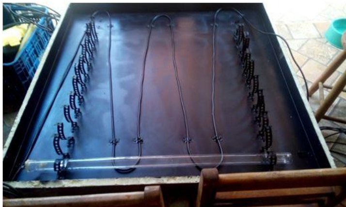
Figura 24: Configuração final dos suportes das tubulações de cobre e dos tubos das lâmpadas.
