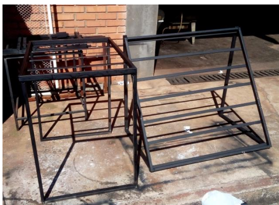
Figura 28: Suportes do coletor solar e do reservatório finalizados.
