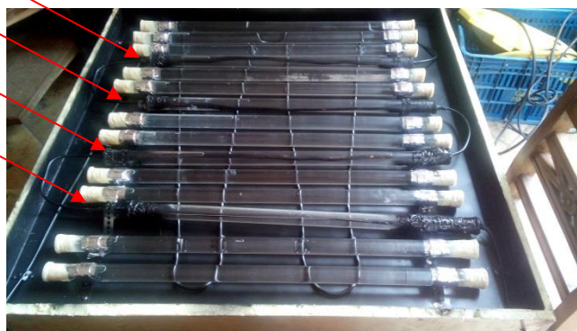
Figura 25: Configuração final do Coletor com a tubulação de cobre e a tubulação das lâmpadas.
