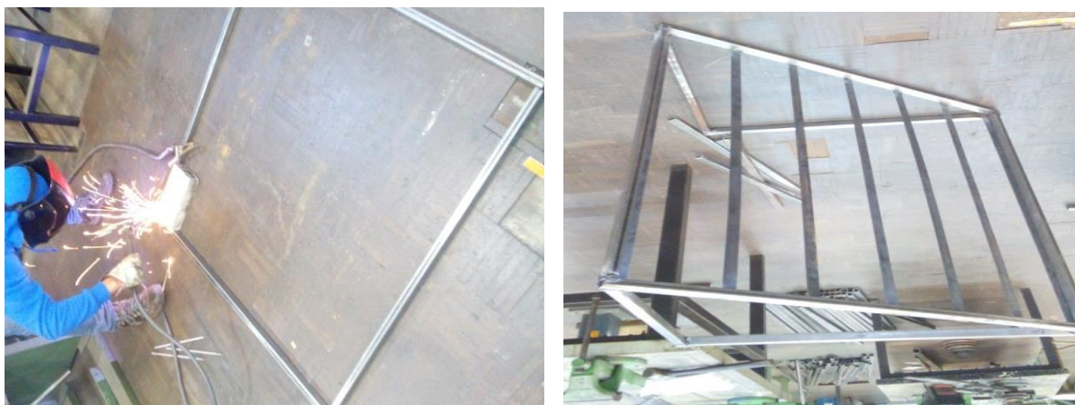
Figura 27: Processo de fabricação do suporte de fixação do coletor solar.
