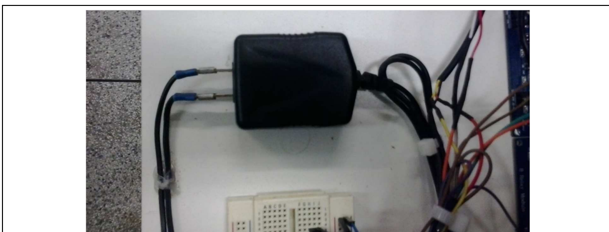
Figura 22 – Fonte de 5V para alimentar o módulo com os relés Fonte: Autores.
