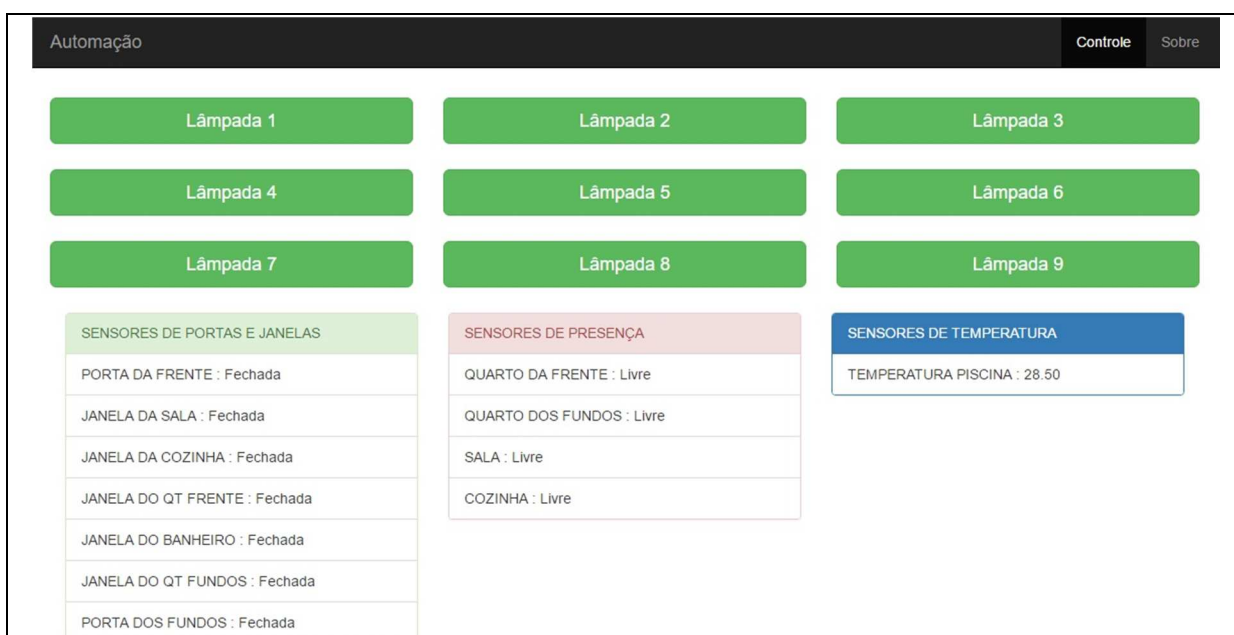
Figura 26 – Teste de acionamento de uma lâmpada pela página web Fonte: Autores.
