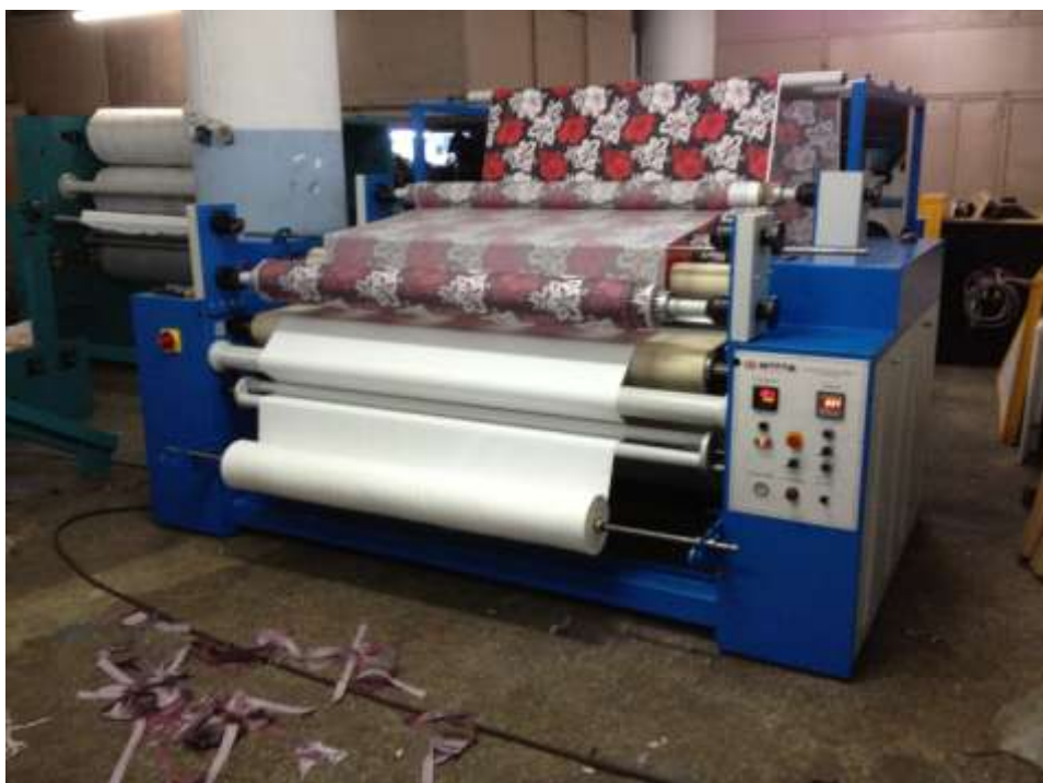
Figura 48: Processo de sublimação em grande formato. Fonte: Portal da sublimação (2010).
