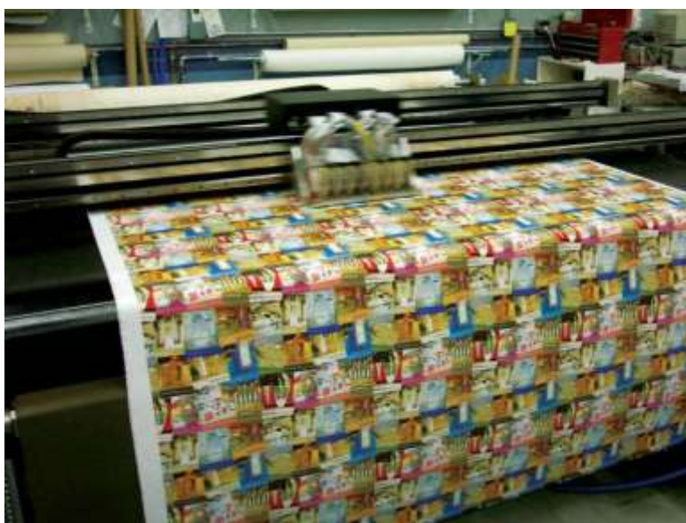
Figura 51: Impressão digital direta sobre tecido. Fonte: FabricGraphicsMaa (2007).
