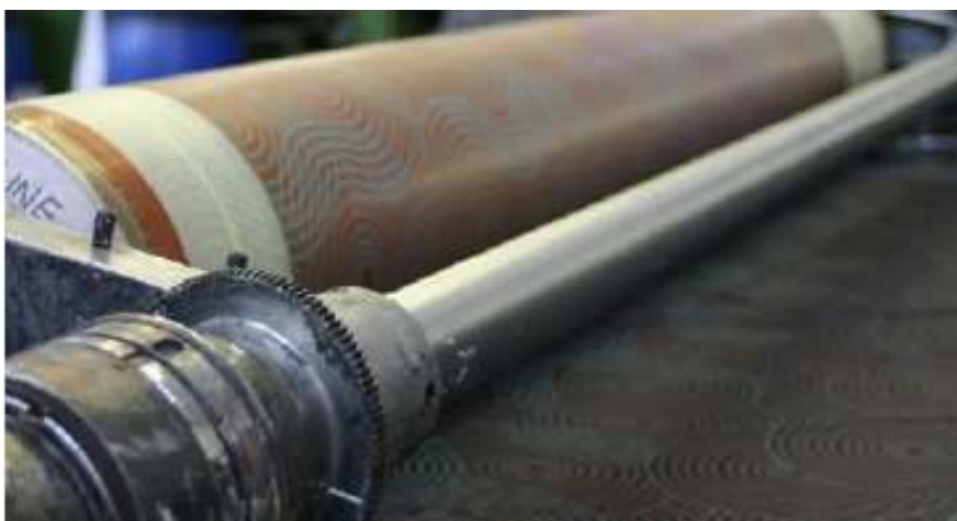
Figura 43: Cilindros microperfurados. Fonte: Imaterial (2013).
