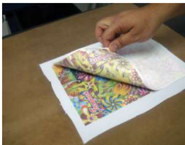
Figura 46: Papel sendo removido, ainda quente. Fonte: Estampa Web (2013).
