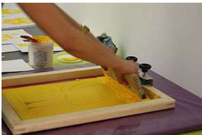
Figura 38: Tinta sendo espalhada na tela. Fonte: Paço das Artes.
