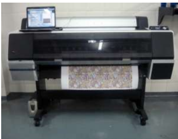
Figura 44: Impressão da imagem, espelhada, em papel especial. Fonte: Estampa Web (2013).
