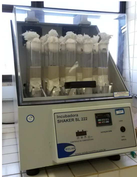
Figura 5 – Agitador incubador: sistema fermentativo
