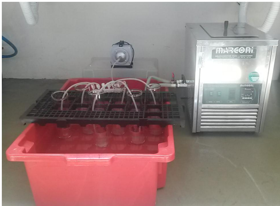
Figura 6 – Sistema de aeração e banho maria para controle da temperatura
