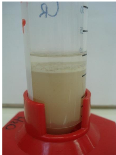
Figura 7 - Análise de teor de O&G pelo método de extração por hexano
