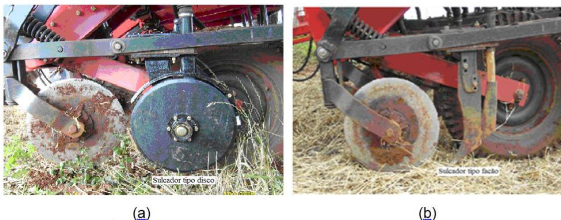
**Figura 3.** Sulcadores utilizados na condução do experimento. Sulcador tipo disco (a) e sulcador tipo haste (b).
