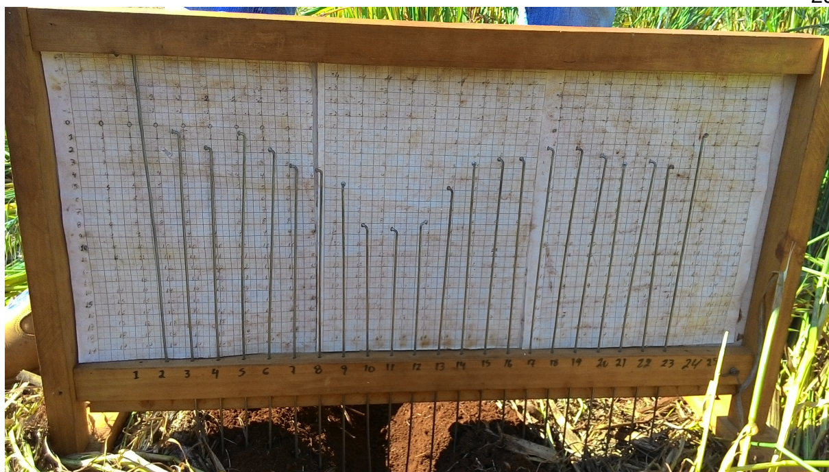
Figura 4 – Vista geral do perfilômetro de madeira utilizado para avaliação da profundidade, largura de sulco e da área de solo mobilizado. UTFPR, Pato Branco - PR, 2017.
