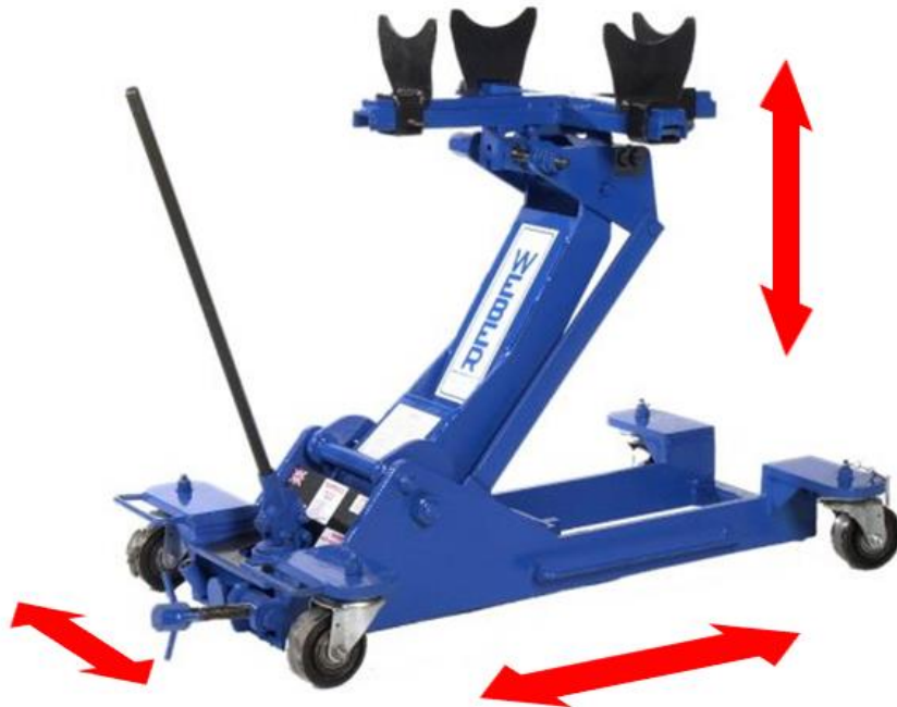
Figura 66 – Exemplo de um carrinho (disponível para aquisição no mercado) para remoção de caixa de transmissão e seus respectivos graus de liberdade Fonte: Ferramenta para remoção de caixa de transmissão WeberUK (2015)
