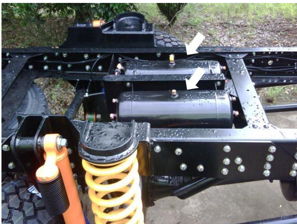
Figura 39 – Exemplo de tanques de ar utilizados em veículos de aplicação pesada
