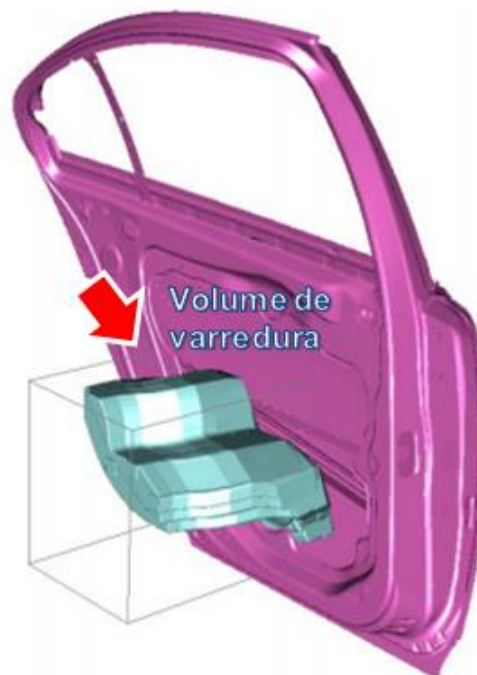
Figura 20 – IPS – Volume de varredura descrito pela geometria (porta objetos) durante sua remoção Fonte: IPS (2011)
