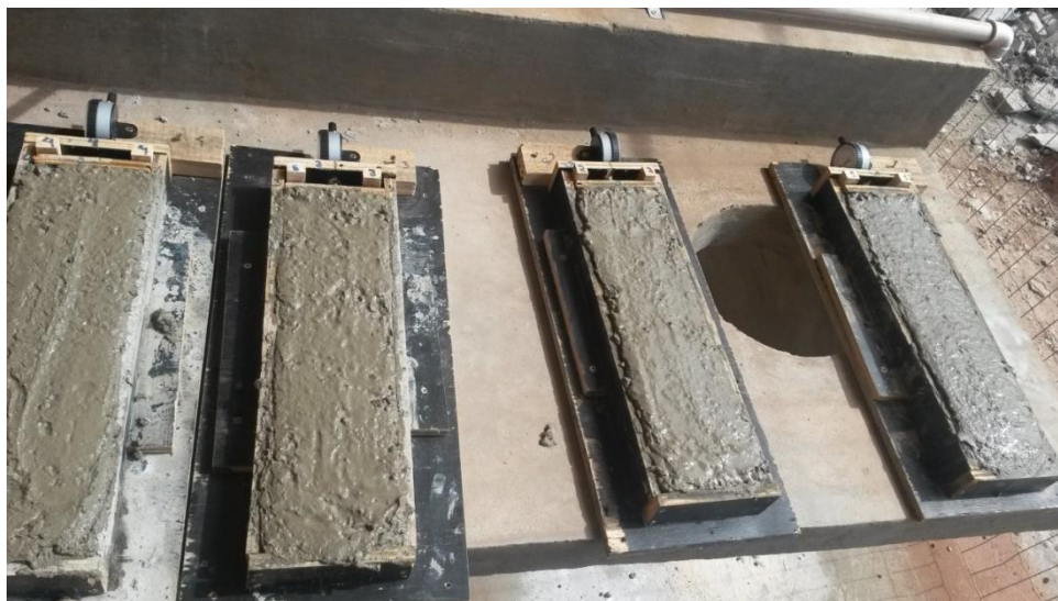
Figura 16- Concretados e regularizado exposto às condições climáticas Fonte: As autoras (2016).
