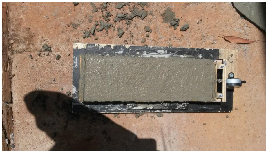
Figura 14- Molde concretado e regularizado exposto às condições climáticas Fonte: As autoras (2016).
