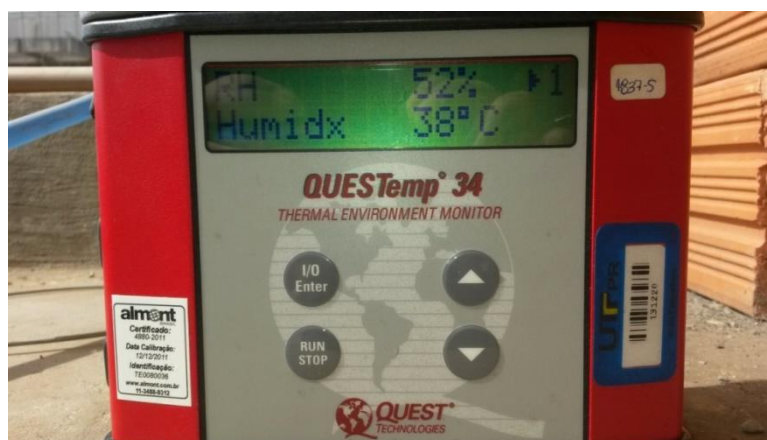
Figura 13- Mensuração da umidade relativa do ar através de termômetro digital Fonte: As autoras (2016).
