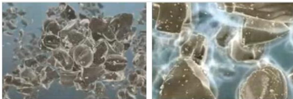
Figura 1- Ilustração computacional da aglomeração das partículas de cimento em pasta isenta de dispersante (esquerda) e com o aditivo adsorvido na superfície (direita) Fonte: Romano, Cardoso e Pileggi (2011, P. 482).
