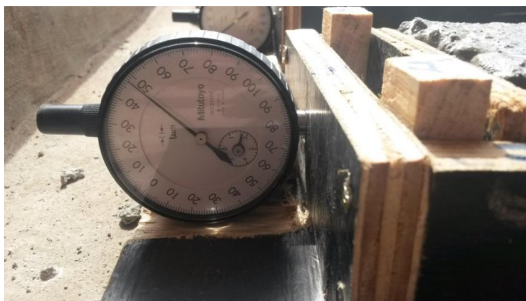
Figura 10- Molde acoplado ao relógio comparador Fonte: As autoras (2016).
