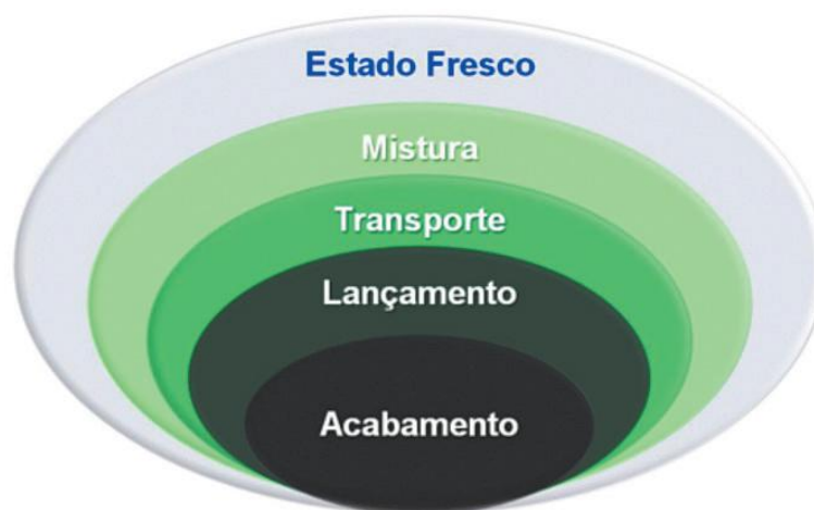
Figura 2 - Ilustração esquemática do conceito abrangente de trabalhabilidade, envolvendo as etapas de mistura, transporte, lançamento e acabamento Fonte: Romano, Cardoso e Pilleggi (2011, P. 456).
