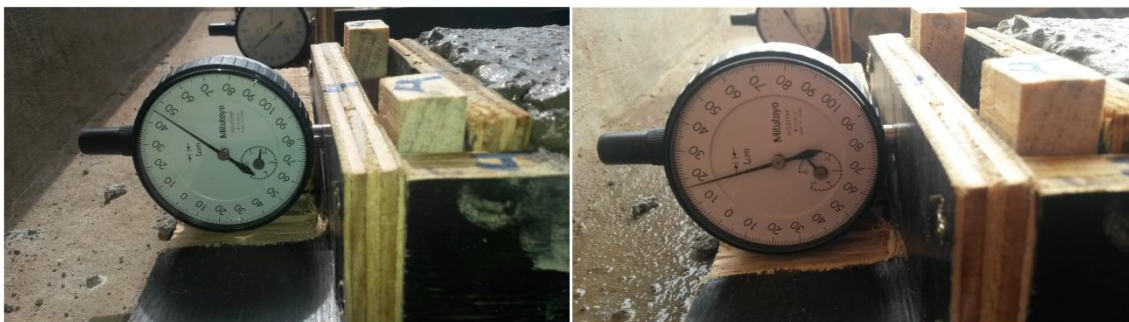
Figura 11-a)Obtenção dos resultados através do valor inicial no relógio comparador b) Obtenção dos resultados através do final no relógio comparador Fonte: As autoras (2016).
