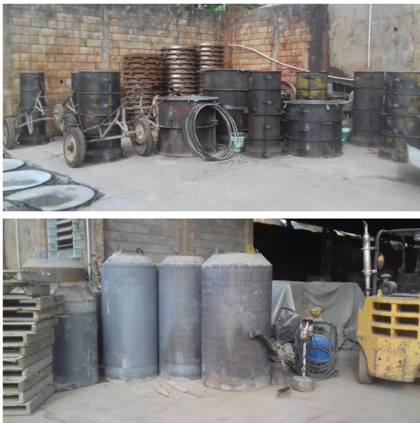
Figura 19 - Formas responsáveis pela conformação dos tubos Fonte: Autoria Própria (2018).
