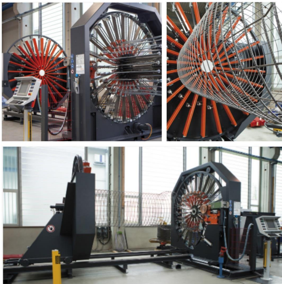
Figura 33 - Máquina de soldar armadura Fonte: Mbk stronger connections (2018).
