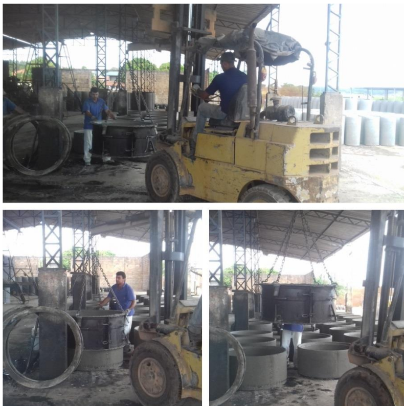
Figura 23 - Desforma final Fonte: Aatoria Própria (2018).
