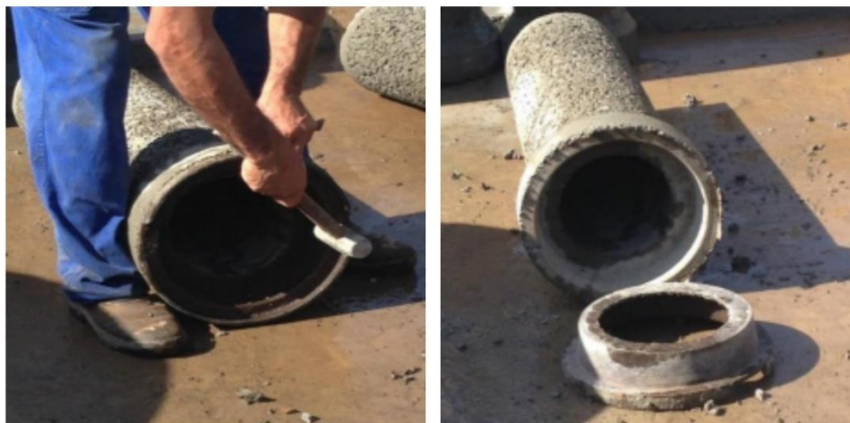
Figura 24 - Desforma do anel de sustentação da peça Fonte: Autoria Própria (2018).
