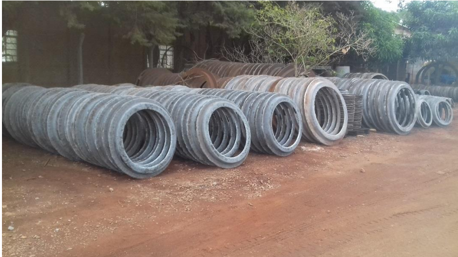
Figura 20 - Anéis para vedação do fundo das formas Fonte: Autoria Própria (2018).
