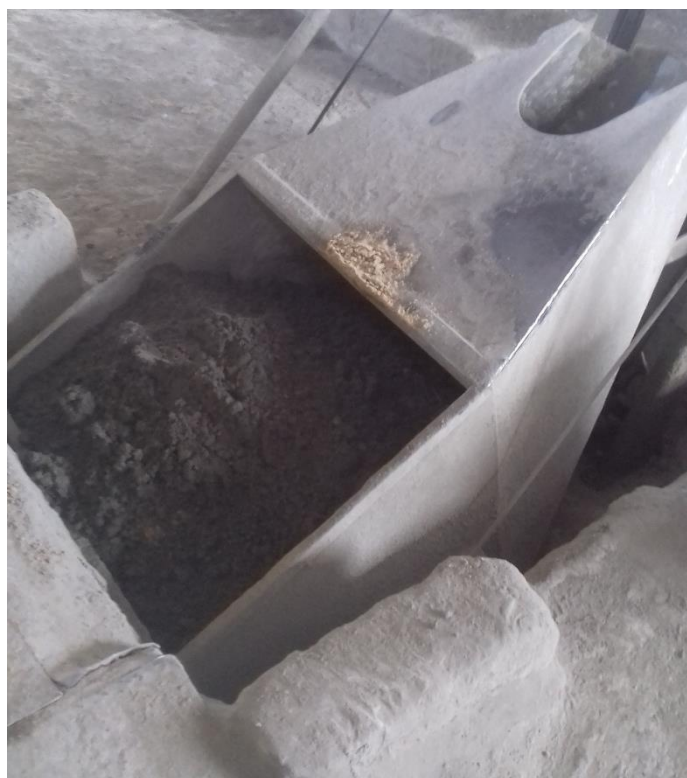
Figura 17 - Caçamba onde se despeja os componentes do concreto Fonte: Autoria Própria (2018).
