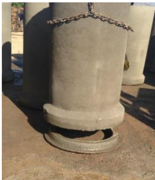
Figura 25 - Tubo sendo levantado pela empilhadeira para retirada do anel Fonte: Autoria Própria (2018).
